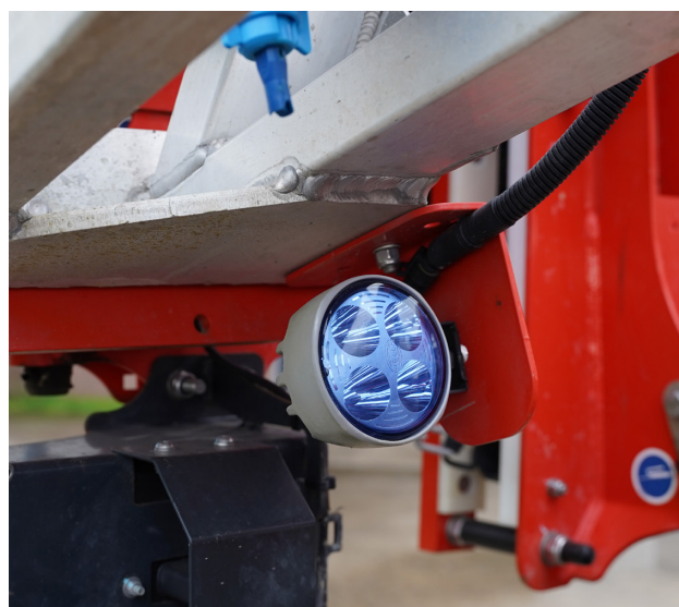
Verlichting op de spuitboom is handig tijdens de onkruidbestrijding in de donkere wintermaanden.
