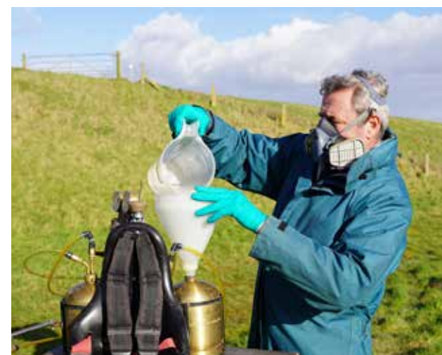
Met de proefveldspuit kunnen twee middelen (combinaties) worden gespoten. De werkdruk op de spuitboom is ca. 2,7 bar.
