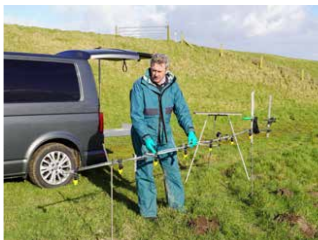
De proefveldspuit wordt klaargezet op een stellage. De gedragen spuit - die uit meerdere onderdelen bestaat - is 3 meter breed. De opbouw vergt ongeveer een kwartier.
