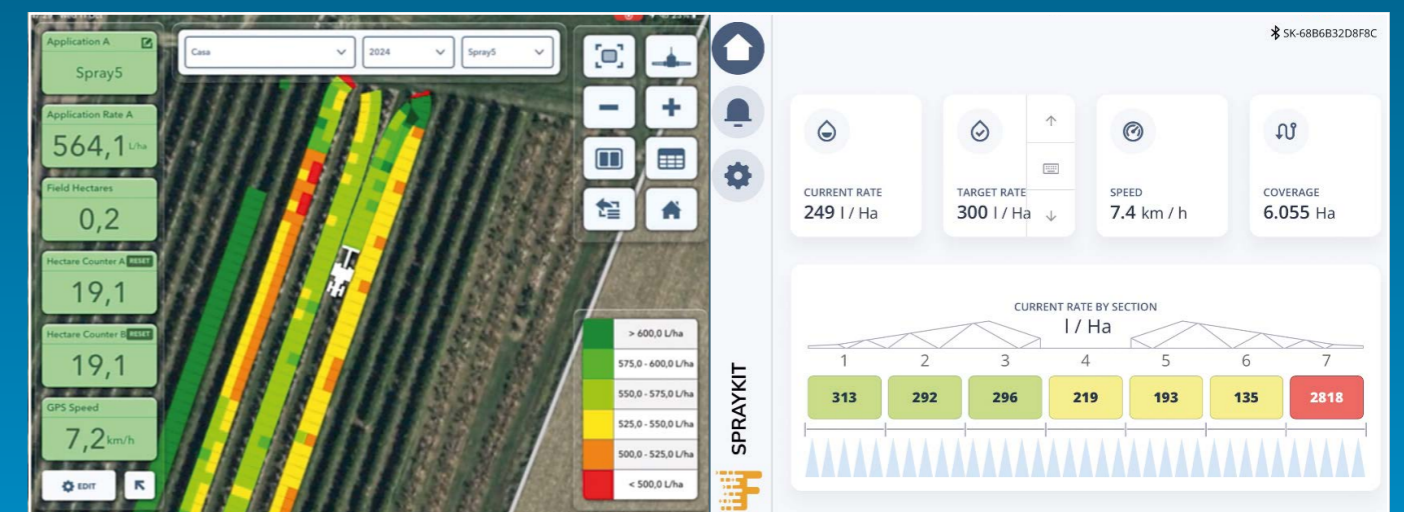
Monitorizarea în timp real a cantității distribuite în FieldView™ Cab și aplicația Spray Kit (pentru calibrare)
