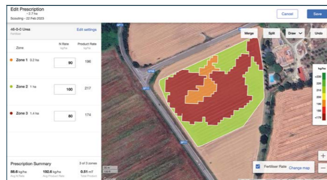
Auto Zoning ajută la generarea unei hărți de prescripție pentru rata variabilă de aplicare a azotului.
